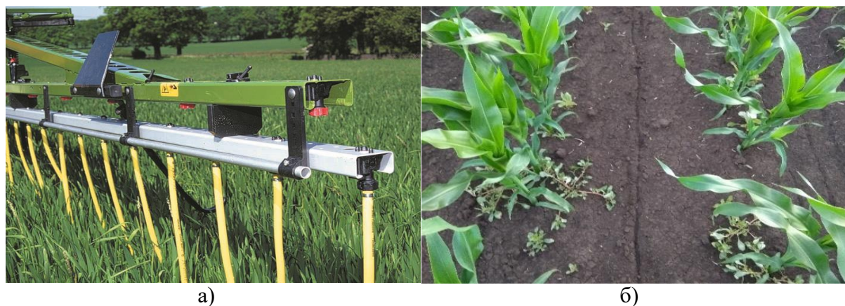
Рис. 1. Внекорневая подкормка сельхозкультур: а)-шланги удлинители; б)-следы КАС на почве после прохода опрыскивателя со шлангами удлинителями
