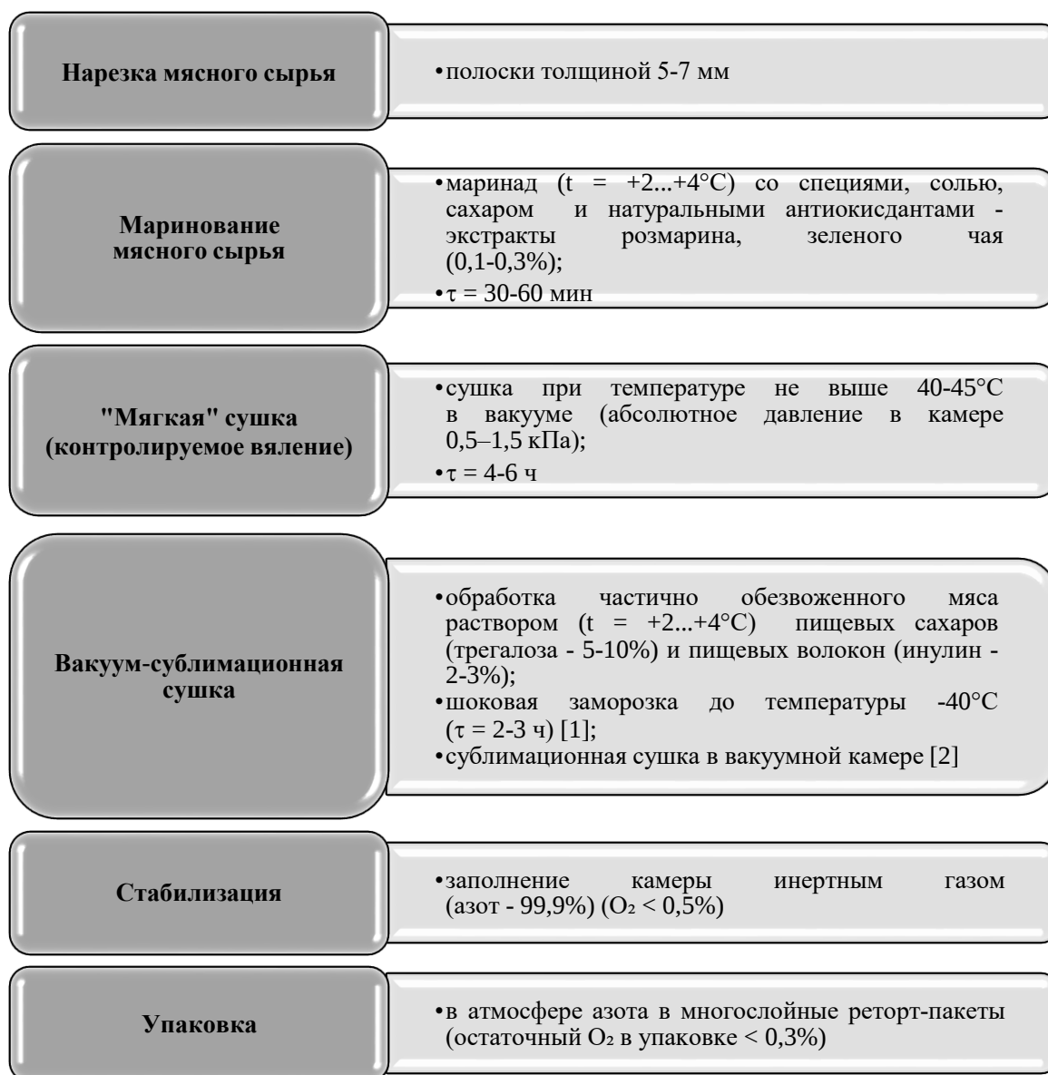
Рис. 1. Технологическая схема изготовления мясных снеков комбинированным вакуумно-сублимационным методом с предварительной криопротекцией
