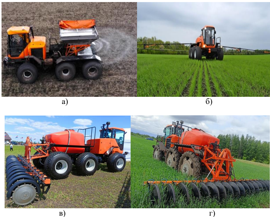
Рис.2. Комплекс «Туман»: а)-разбрасыватель; б)- опрыскиватель; в)-мульти-инжектор; г)- мульти-инжектор на подкормке пшеницы яровой твердой «Безенчукская золотистая»
