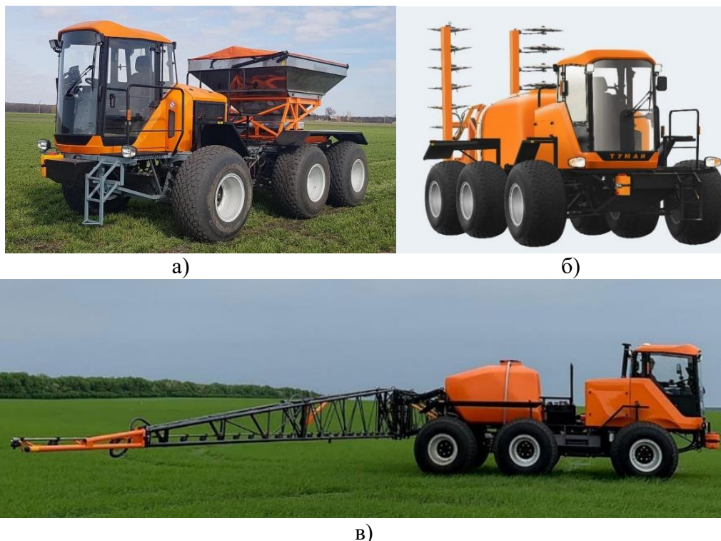
Рис.1. Комплекс «Туман-3» (третьего поколения) производства ООО «Пегас-Агро»: а)-разбрасыватель твердых минеральных удобрений; б)-мульти-инжектор; в)-штанговый опрыскиватель
