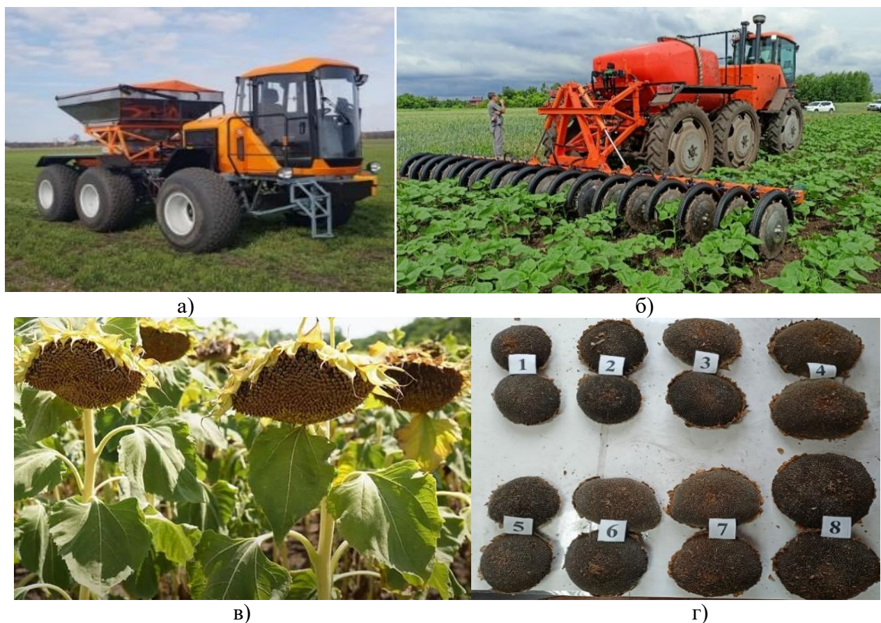
Рис.2. Комплекс «Туман»: а)-разбрасыватель; б)-мульти-инжектор подкормка КАС (фаза-3-5 настоящих листьев); в)-подсолнечник; г)-корзинки в опыте
