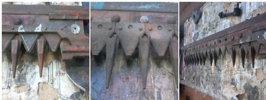
Рис. 3. Крепление пальца к брусу
