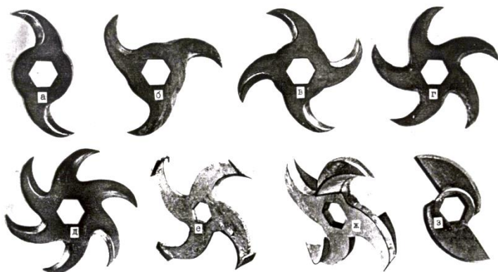
Рис. 1. Типы монофрез: а-д – дисковые; е – с Т-образными ножами; ж – с отвальными элементами; з – винтовые
