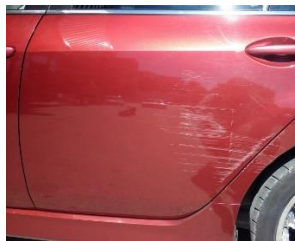
Рис. 1. Повреждения кузова автомобиля: а – притир; б – лобовые повреждения; в – фронтальные повреждения
