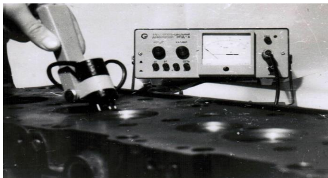
Рис. 2. Общий вид прибора ЭПД-6 с измерительным датчиком и объектом измерения
