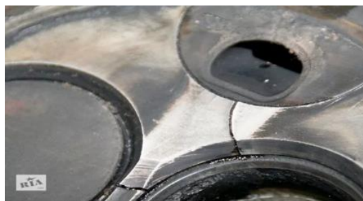
Рис. 1. Трещины межклапанных перемычек
