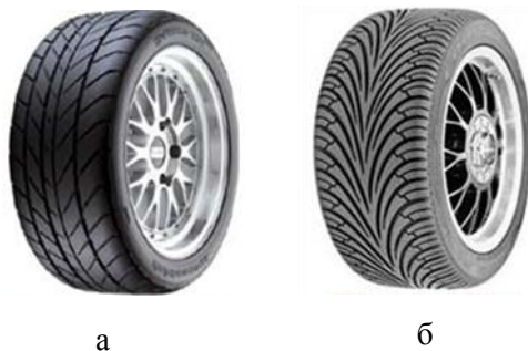
Рис. 2. Рисунок протектора: а – дорожный рисунок протектора; б – «дождевой» рисунок протектора
