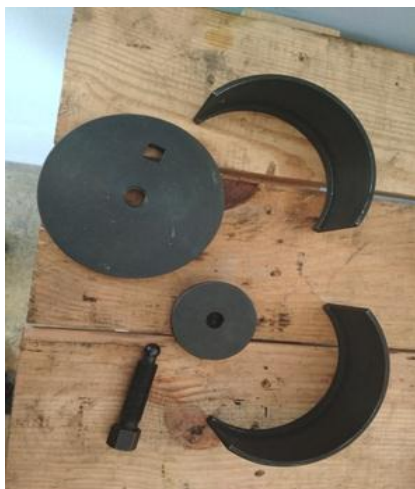
Рис. 2. Приспособление для снятия сальника коленвала и запрессовки John Deere: а – для снятия; б – для запрессовки
