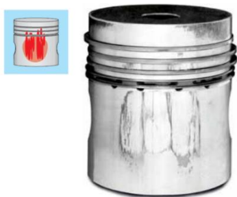
Рис 2. Повреждения поршня из-за работы без масла
