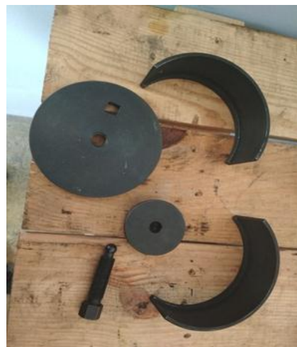
Рис. 2. Приспособление для снятия сальника коленвала и запрессовки John Deere: а – для снятия; б – для запрессовки
