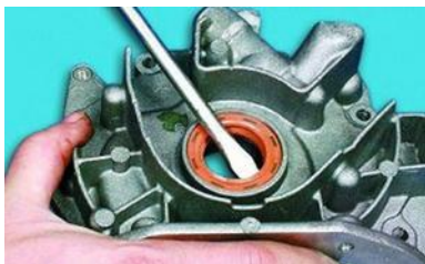
Рис. 1. Способы выпрессовки сальников: а – саморезами; б – отверткой
