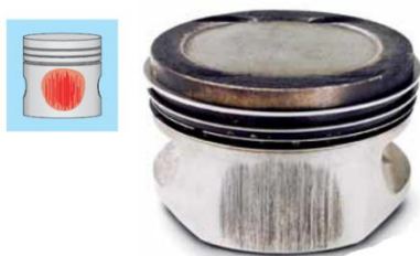
Рис 3. Повреждения поршня при переполнении топливом
