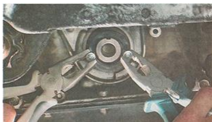
Рис. 1. Способы выпрессовки сальников: а – саморезами; б – отверткой
