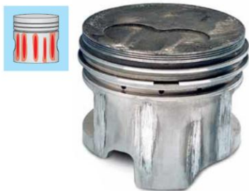
Рис. 1. Повреждения поршня из-за недостаточного зазора
