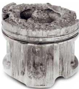
Рис 4. Механическое разрушение поршня от перегрева
