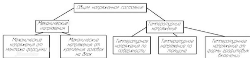
Рис. 1. Напряженное состояние огневого днища головки блока цилиндров дизеля
