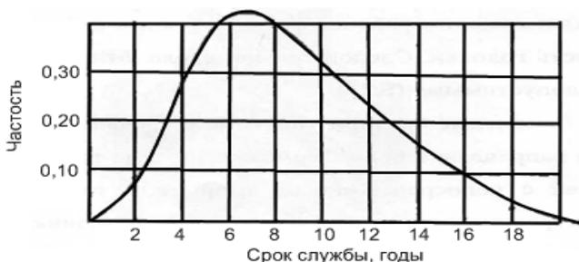
Рис. 3. Зависимость частоты образования трещин в межклапанных перемычках головки цилиндров дизелей ЯМЗ-238НБ, от времени
