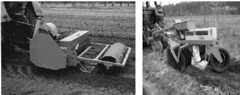
Рис. 3. Лесные сеялки СЛН-5 -5 слева, SZU – слева
