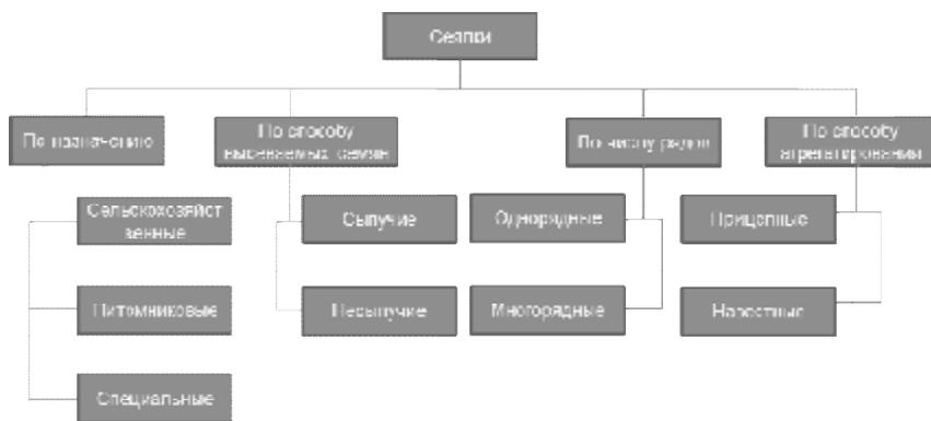
Рис. 1. Классификация посевных машин
