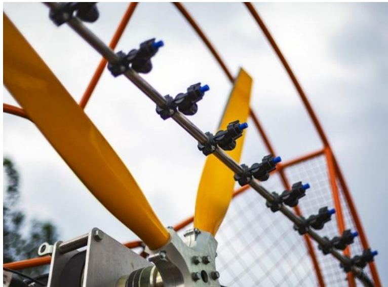
Рис. 2. Форсунки и вентилятор опрыскивателя «Туман»
