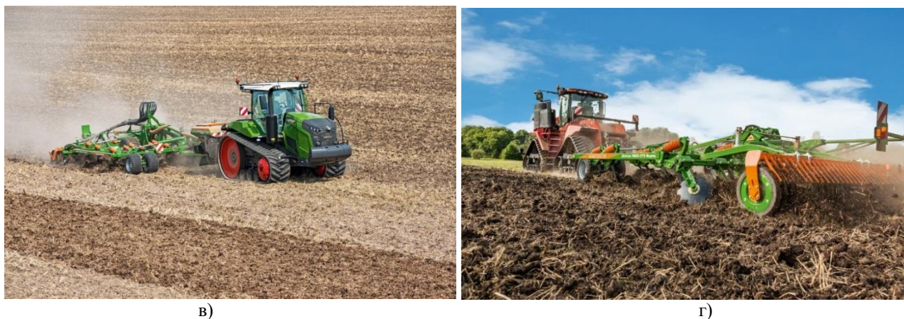
Рис.3. Универсальные мульчирующие культиваторы Ceniux шириной захвата от 3м до 8 м в агрегатах с различными по мощности тракторами
