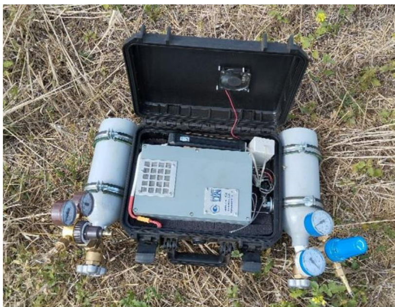
Рис. 1 Мобильный аналитический комплекс на базе портативного хроматографа «ПИА» на основе микрофлюидных систем
