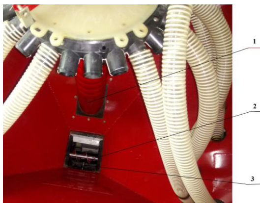
Рис. 1. Винтовое устройство подачи семян пневматической сеялки: 1 – вертикальное распределяющее устройство; 2 – винтовое устройство подачи семян; 3 – высевальный аппарат
