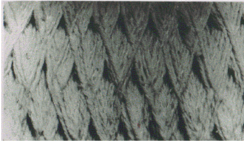
Рис. 2. Внешний вид аэратора спиралевидного строения намотки
