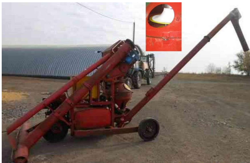
Рис. 1. Общий вид протравливателя семян с двухпоточной системой распределения семян
