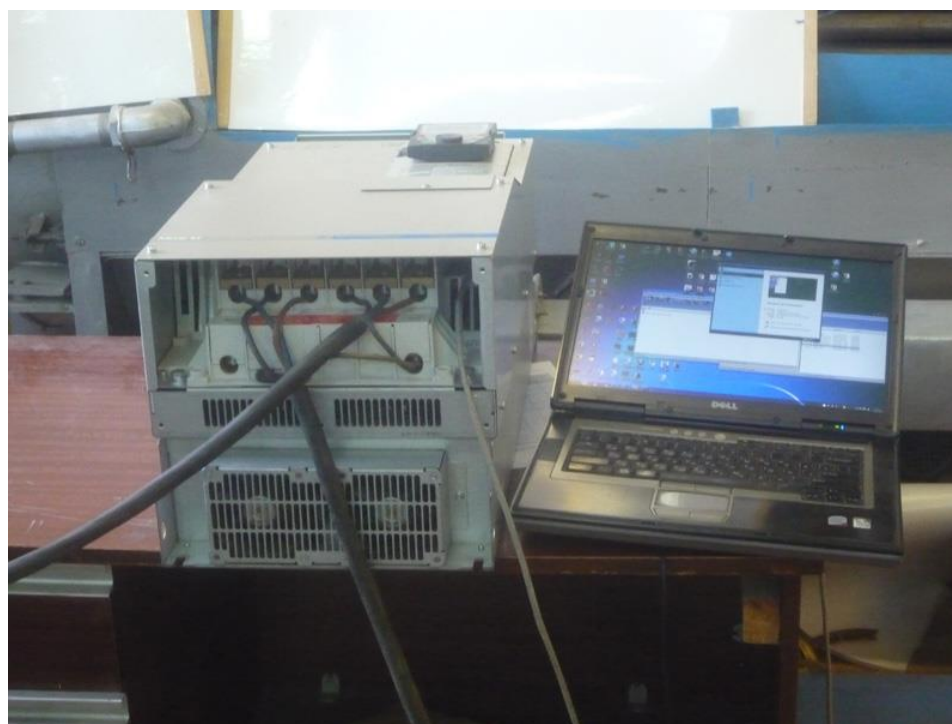
Рис. 5. Частотный преобразователь (слева) и ноутбук для управления электродвигателем измельчителя
