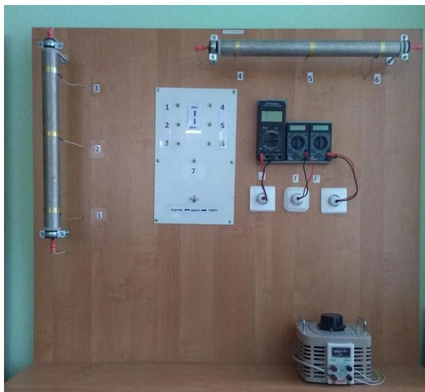
Рис. 2. Общий вид лабораторной установки для определения коэффициента теплоотдачи трубы при свободном движении воздуха
