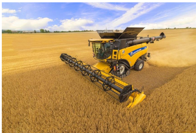
Рис. 2. Комбайн New Holland с аксиально расположенным ротором
