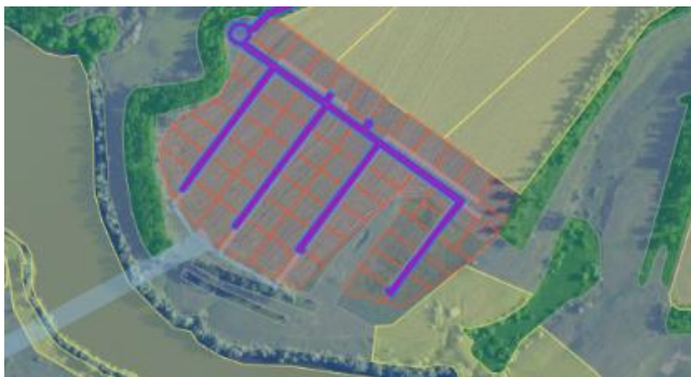
Рис. 2. Пример отображения охранной зоны распределительного газопровода
