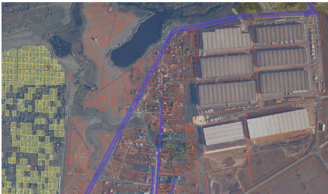
Рис. 4. Пример отображения охранной зоны электросетевого комплекса
