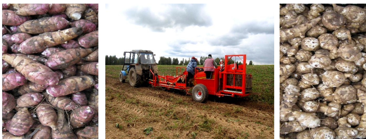
Рис. 1. Комбайн для уборки селекционно-семеноводческих посадок с погрузкой клубней в контейнеры, изготовленный ВИМ и клубни топинамбура в контейнере после уборки с/с комбайном и сортировки
