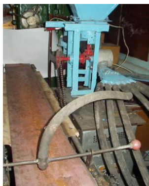
Рис. 1. Высев семян на липкую ленту разными экспериментальными высевающими аппаратами
