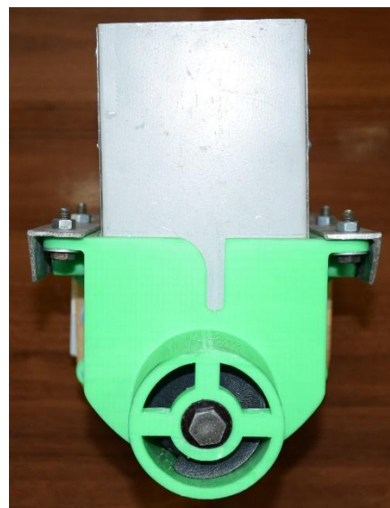
Рис. 1. Шнековый дозатор: а) 3D-модель; б) общий вид
