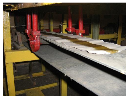
Рис. 1. Высев семян на липкую ленту разными экспериментальными высевающими аппаратами
