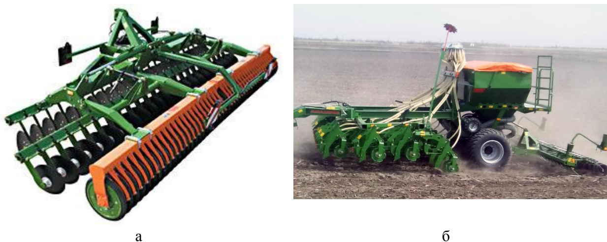
Рис.2 Техника для влагосберегающих технологий фирмы «Amazone-Werke»: а) дисковая борона «Catros-6001»; б) сеялка прямого посева «ДМС-Primera 300»
