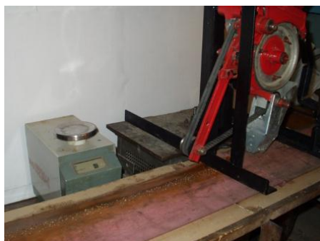
Рис. 1. Высев семян на липкую ленту разными экспериментальными высевающими аппаратами
