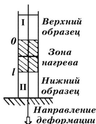
Рис. 1. Схема расположения образцов перед нагружением
