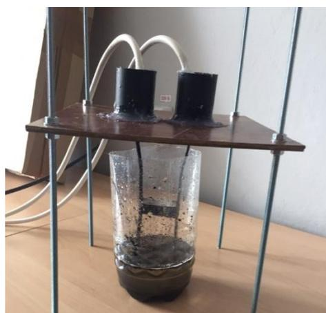
а) трансформатор, конденсатор, формирующий промежуток; б) емкость с рабочим промежутком
