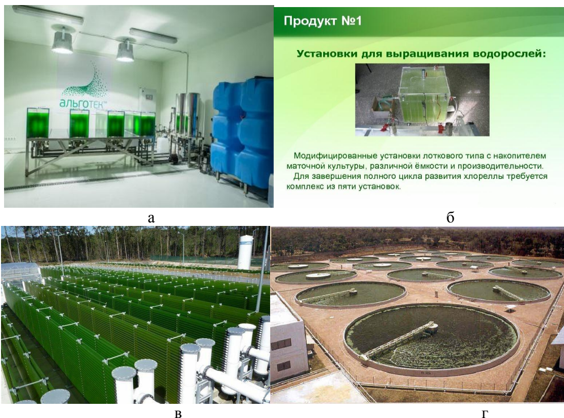
Рис.2. Производство сине-зеленых водорослей в искусственных условиях: а- аквариумах, б-установка для выращивания водорослей, в фотобиореактор для водорослей, г-водоем с мешалкой для производства спирулины и хлореллы (открытые источники)
