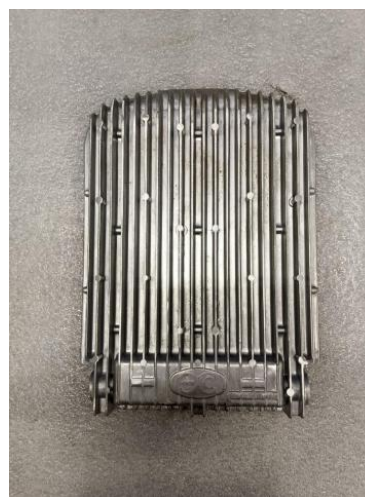
Рис. 2. Подготовленный к покраске алюминиевый корпус светильника
