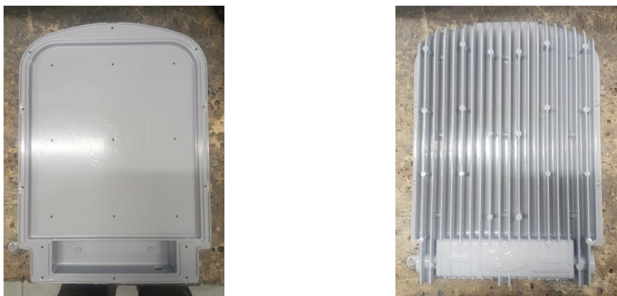
Рис. 3. Окрашенный и готовый к сборке корпус светильника
