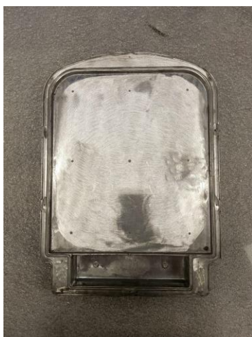
Рис. 2. Подготовленный к покраске алюминиевый корпус светильника
