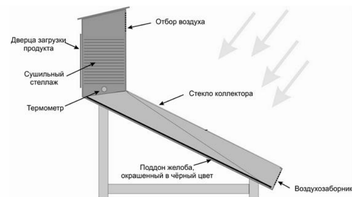
Рис. 2. Сушка сельскохозяйственных культур с помощью солнечного коллектора
