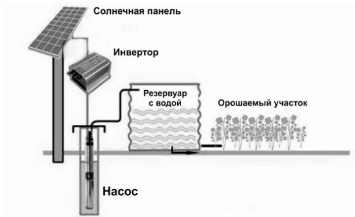
Рис. 1. Использование солнечных насосов для закачки воды в резервуары и орошения
