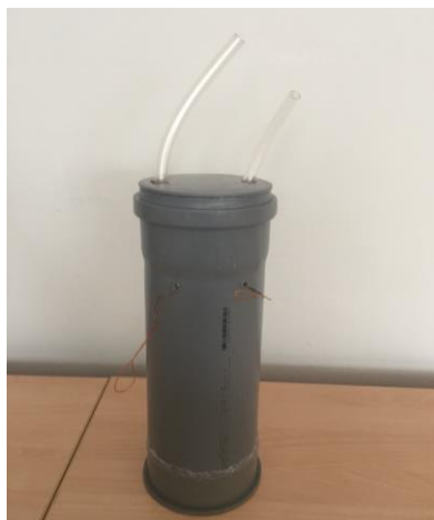
Рис. 2. Общий вид экспериментальной установки омагничивания воды
