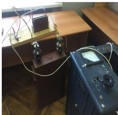
Рис. 2. Лабораторная установка для электрогидравлической обработки
