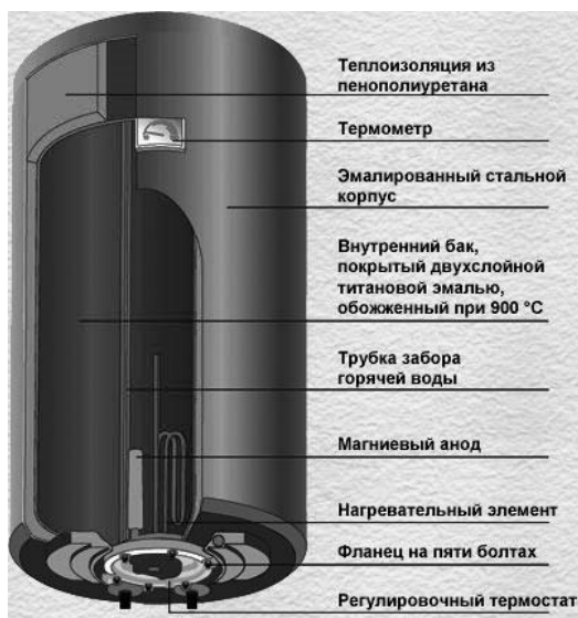
Рис. 1. Устройство электрического водонагревателя
