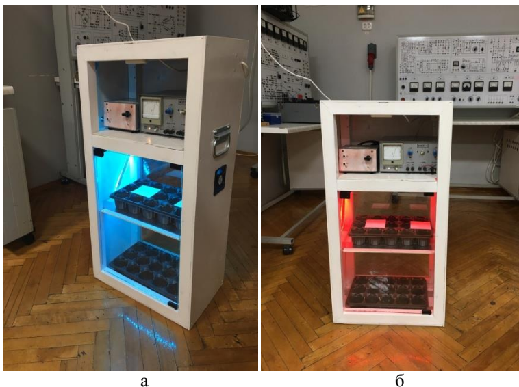
Рис. 2. Общий вид модели предлагаемой биотехнологической установки: а – с синим спектром освещения; б – с красным спектром освещения
