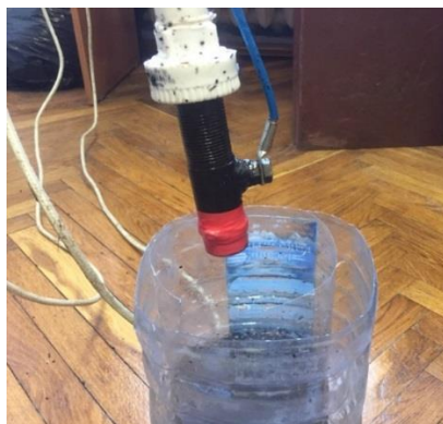
Рис. 2. Лабораторная установка для электрогидравлической обработки
