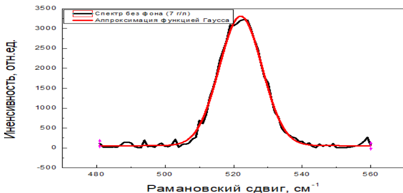
Рис. 5. Спектры КРС на Si НЧ (7 г/л) в отсутствии фона
