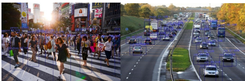
Рис. 1. Распознанный объект отмечен рамкой, над который указан тип объекта и уверенность нейросети в определении объекта
