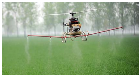
Рис. 3. Беспилотный летательный аппарат для распределения жидких материалов
