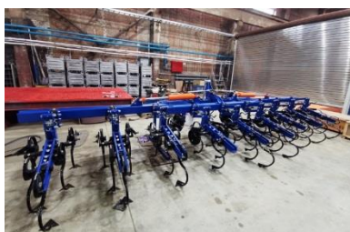
Рис. 3. Культиваторы для междурядной обработки Болеро-6,4: а – общий вид; б – рабочие органы
