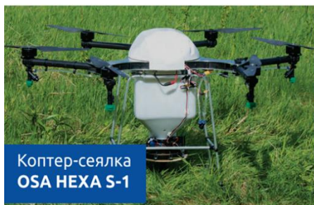
Рис. 2. Подвесная сеялка-разбрасыватель «S-1» в составе универсальной беспилотной авиационной системы «OSA HEXA»
