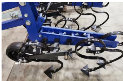
Рис. 3. Культиваторы для междурядной обработки Болеро-6,4: а – общий вид; б – рабочие органы
