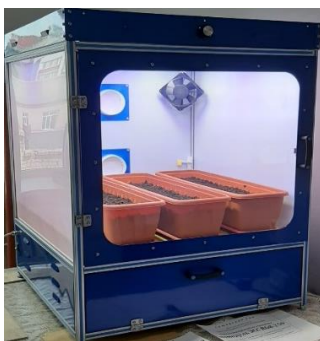
Рис. 1. Лабораторная установка для ускоренного выращивания овощных культур
