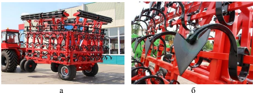
Рис. 4. Средний культиватор Agromaster TILLERMASTER-12 а – общий вид; б – рабочие органы
