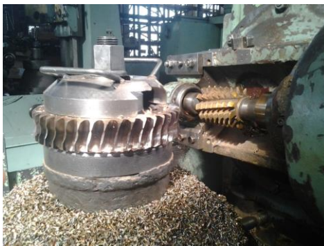
Рис. 1. Нарезка зубьев червячного колеса
