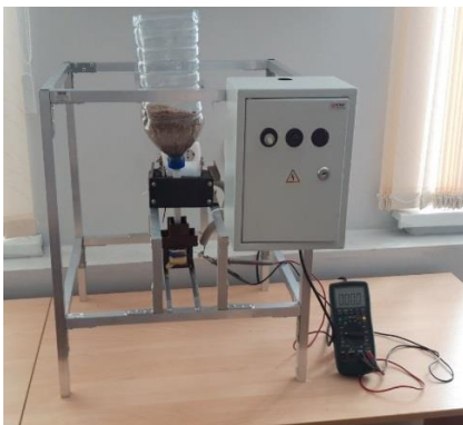
Рис. 1. Общий вид лабораторной установки магнитной стимуляции семян
