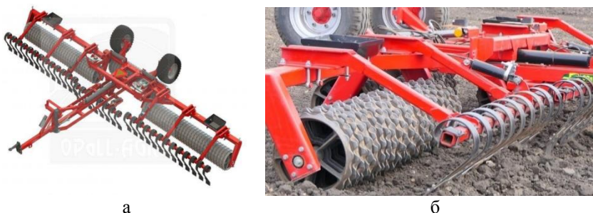
Рис. 5. Каток прикатывающий кольцато-зубчатый Cambridge VEGA II 8,3: а – общий вид; б – каток
