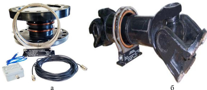
Рис. 3. Двухкомпонентный датчик (а) для измерения крутящего момента до 50 кН·м и осевого усилия до 150 кН, датчик крутящего момента из карданного вала (б)
