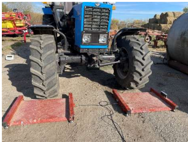
Рис. 2. Измерительный комплекс (весы платформенные электронные МВСК (В) + инклинометром Absoiute Digital Protractor)
