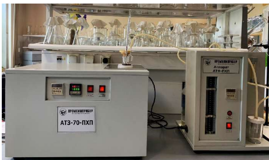
Рис. 3. Прибор АТЗ-70-ПХП для определения низкотемпературных характеристик нефтепродуктов
