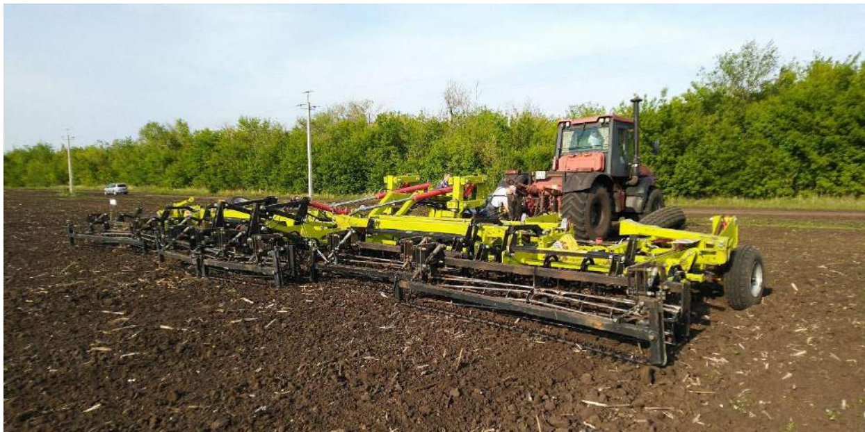
Рис. 3. Культиватор модульный прицепной КМП-14 с ротационной бороней в работе в агрегате с трактором К-744Р1
