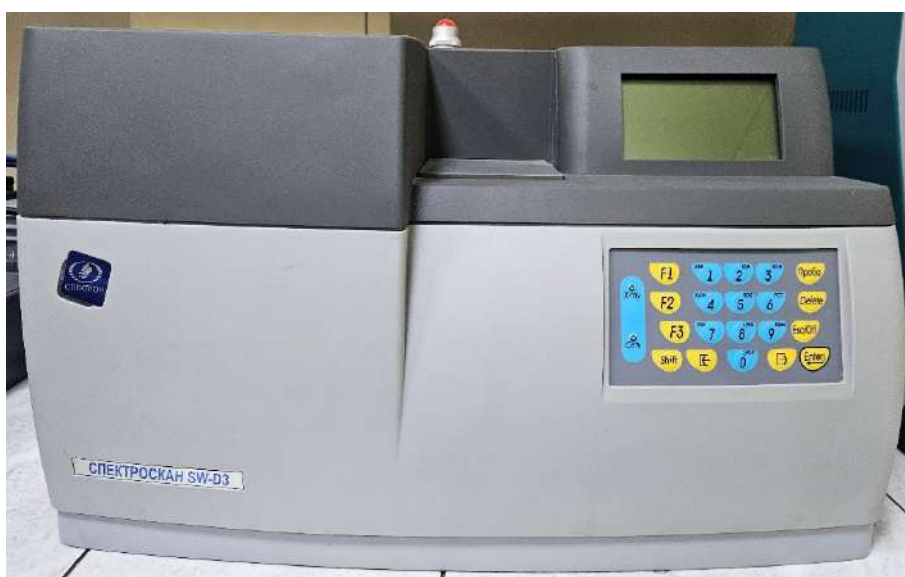
Рис. 4. Анализатор серы «СПЕКТРОКАН SW-D3»
