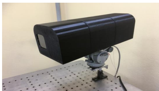
Рис. 2. Гиперспектральная камера на базе оптической схемы Оффнера
