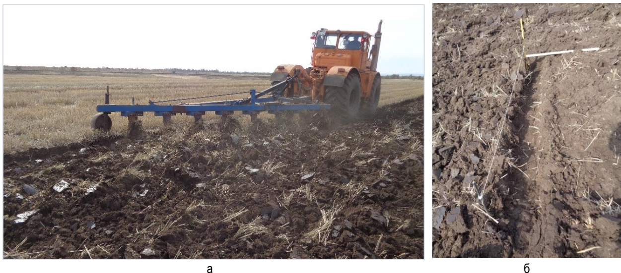
Рис. 2. Исследование заделки стерни: а – вспашка плугом ПНЛ-8-40; б – профиль пахотного слоя
