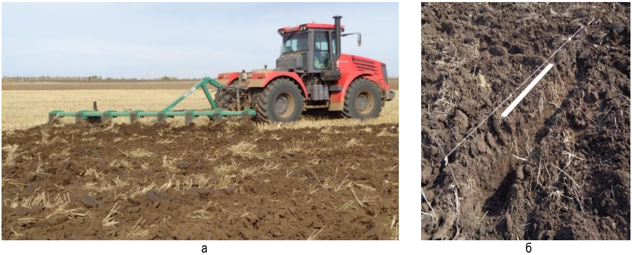
Рис. 3. Исследование заделки стерни: а) вспашка плугом ПБС-8М; б) профиль пахотного слоя
