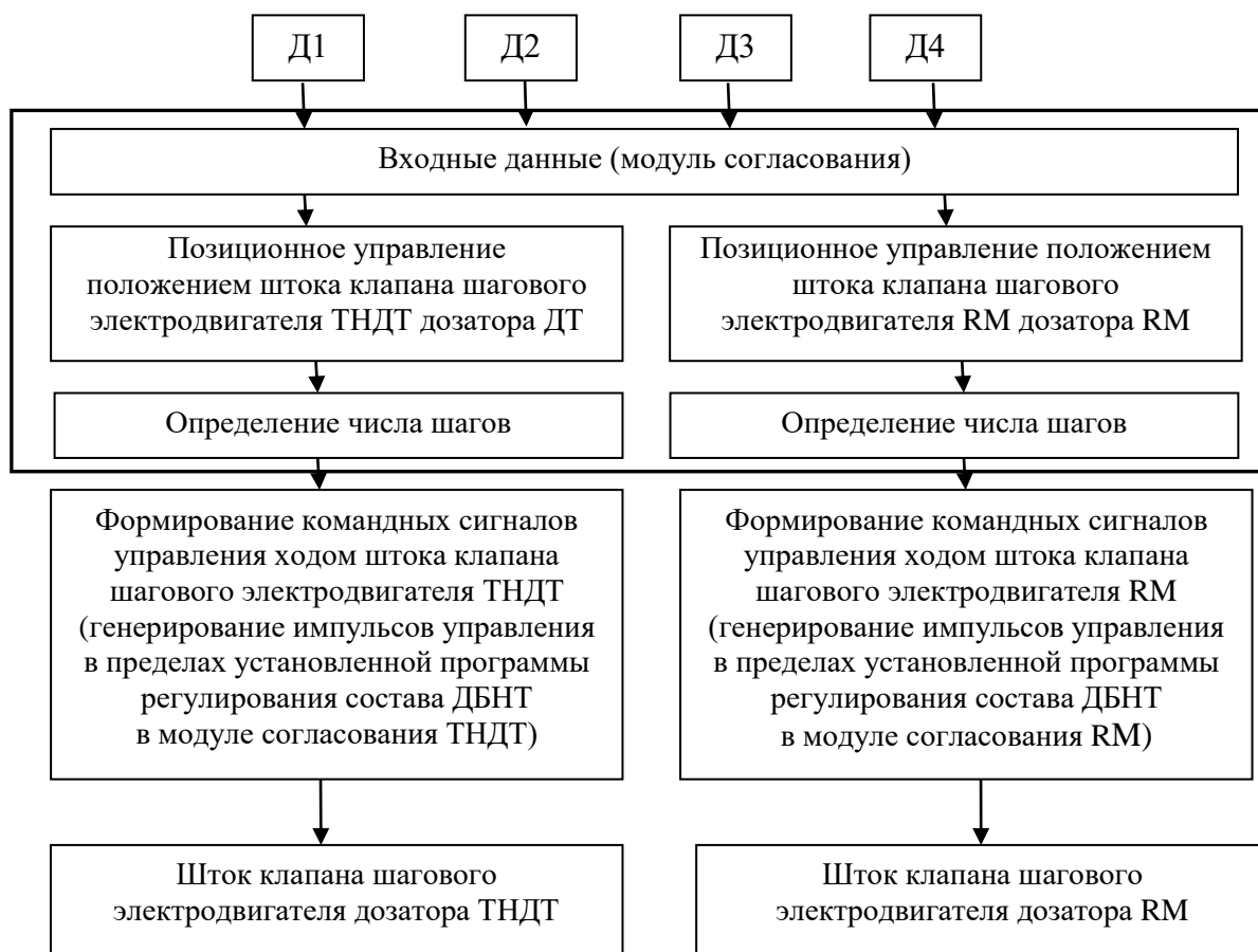
Рис. 3. Блок-схема формирования командных сигналов микропроцессорного блока управления электродозаторами смесителя
