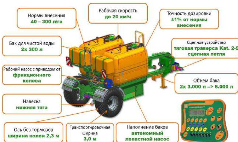
Рис. 7. Агрегат FDC 6000 для оборудования технологических комплексов – сеялок различного типа и назначения компании «AMAZONEN-Werke» для одновременного внесения жидких минеральных удобрений при посеве
