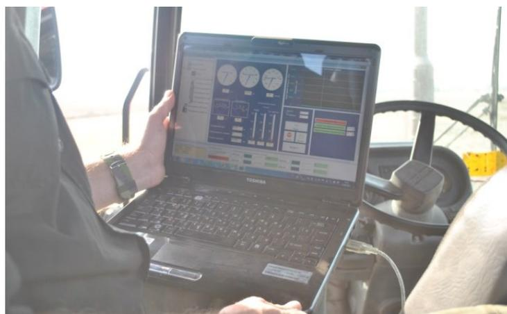
Рис. 5. Портативный компьютер системы ИП-264 с программой сбора и обработки данных измерений
