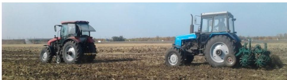
Рис. 4. Проведение энергооценки методом «буксировки»
