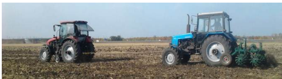
Рис. 4. Проведение энергооценки методом «буксировки»
