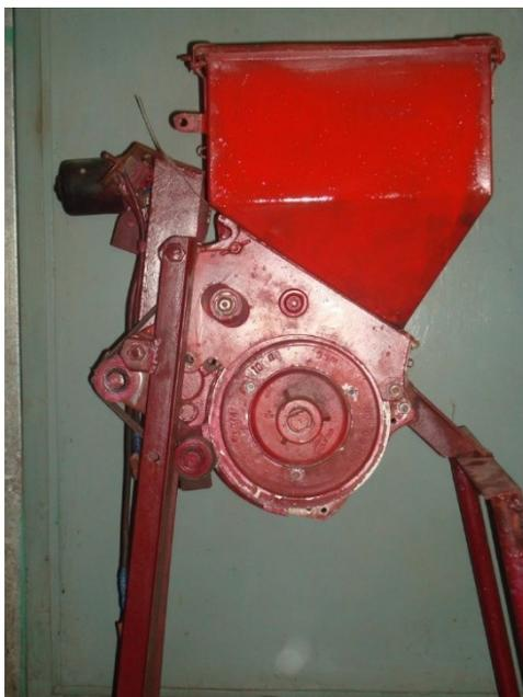
Рис. 3. Экспериментальный высевающий аппарат
