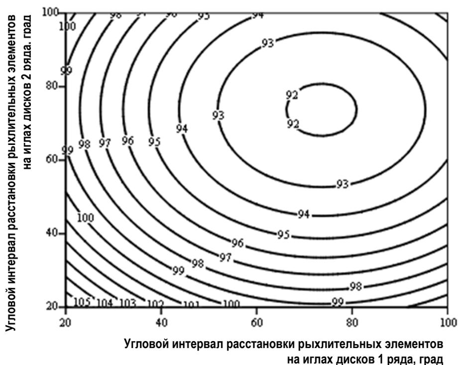
Рис. 5. Факторная зависимость удельного энергопотребления
