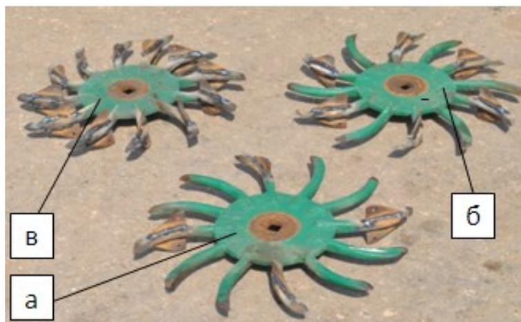
Рис. 3. Дисково-игольчатые рабочие органы первого ряда с плоскими рыхлительными элементами, установленными с интервалом в 90° (а), 60° (б), 30° (в)
