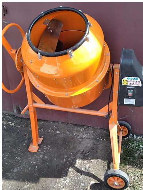
Рис. 1. Исследуемый модернизированный барабанный смеситель с Г-образными лопастями
