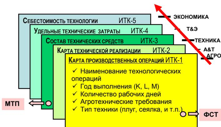
Рис. 1. Структура интегрированной технологической карты
