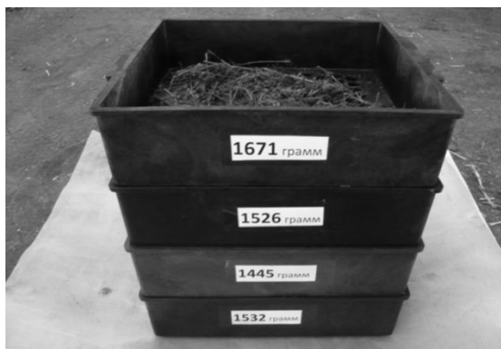
Рис. 1. Секционное сито для определения структуры кормосмеси
