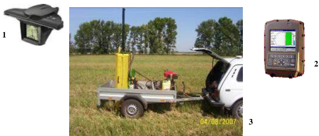
Рис. 1. Общий вид мобильного автоматизированного комплекса для агрохимического обследования: 1 – GPS-приемник навигационной системы AgGPS EZ-Guide Plus; 2 – полевой компьютер AgGPS 170; 3 – автоматический пробоотборник Fritzmeier Profi 90
