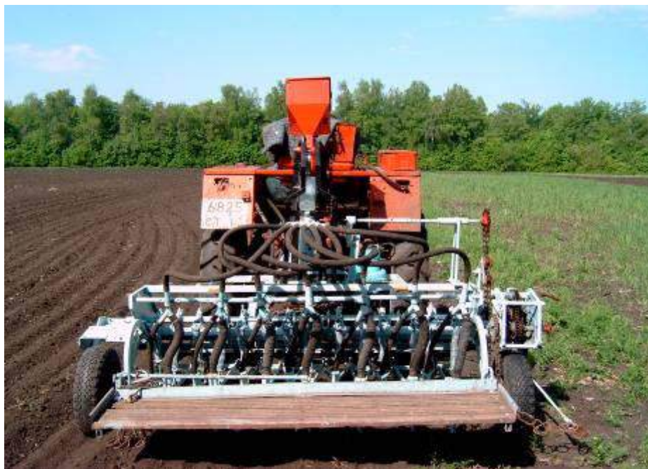
Рис. 1. Экспериментальная селекционная сеялка
