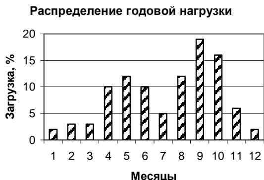
Рис. 2. Распределение годовой загрузки с/х тракторов
