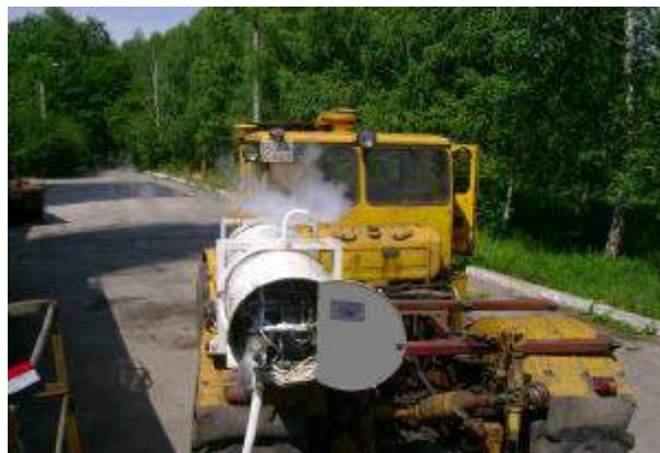
Рис. 5. Заправка бака БКТ-300 сжиженным природным газом метан
