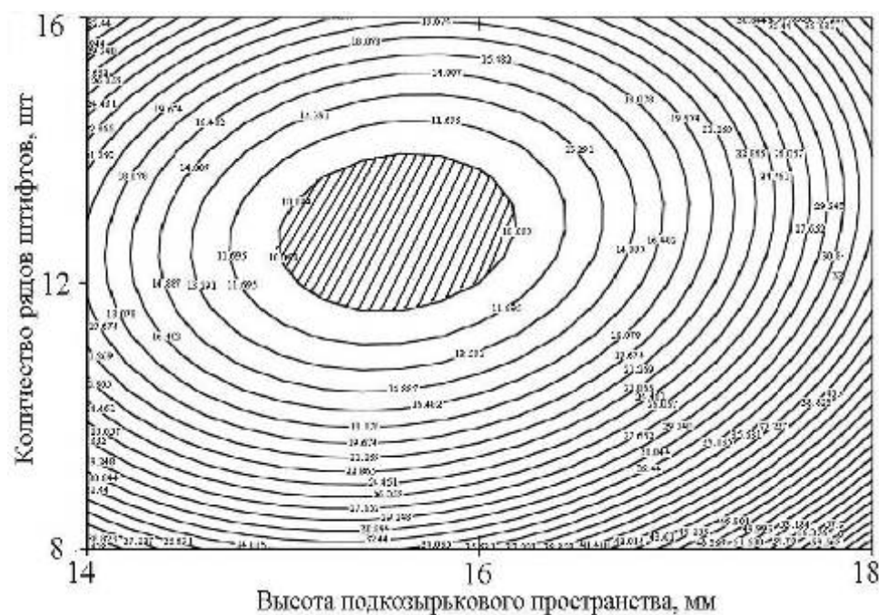
Рис. 5. Двухмерные сечения поверхности отклика равномерности высева от конструктивно-режимных параметров
