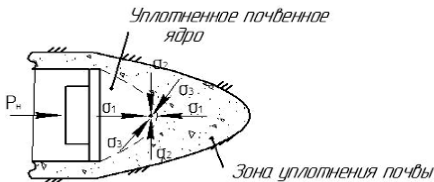
Рис. 1. Схема уплотненного почвенного ядра с возникающими в нем нормальными напряжениями
