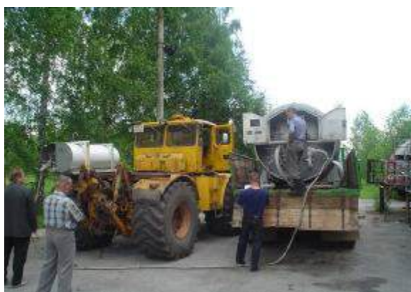
Рис. 4. Удаление воздуха из бака БКТ-300 и газопроводов топливной системы и «охлаждение» бака жидким азотом
