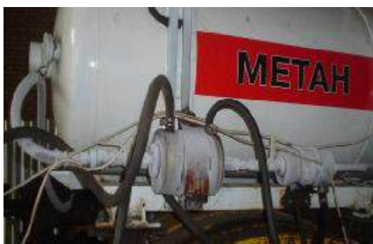
Рис. 6. Обледенение теплообменников и газопроводов при работе двигателя в газодизельном режиме на нагрузках, близких к максимальным
