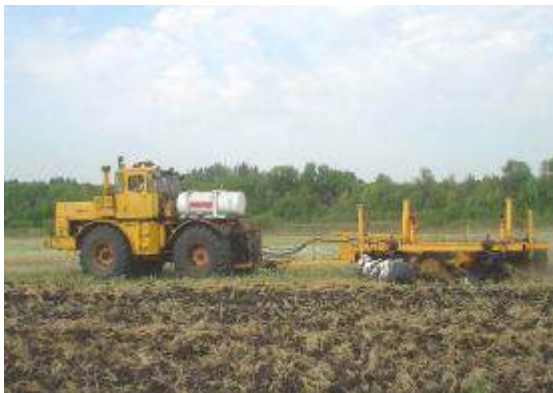
Рис. 7. Вид трактора К-701 в работе с дисковой бороной БДТ-5,8 ЭТМ
