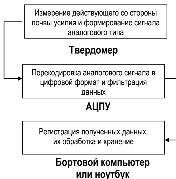
Рис. 2. Технологическая схема работы предлагаемого твердомера с измерительным комплексом
