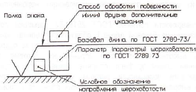
Рис. 1. Структура обозначения шероховатости поверхности
