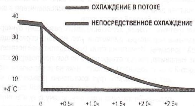
Рис.3. Сравнительная скорость охлаждения для двух способов замораживания молока, так как в качестве хладагента используется вода. Огромная площадь теплообмена (3 м 3 ) и высокая скорость потоков жидкости по обе стороны пластин позволяют за очень короткое время охладить молоко.
