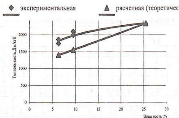
Рис.1 График зависимости теплоемкости зерна сои от влажности
