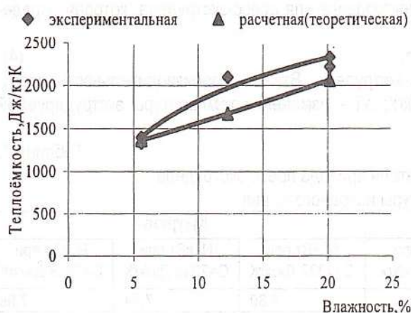
Рис.3. График зависимости теплоемкости зерна кукурузы от влажности
