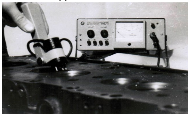
Рис. 2. Общий вид прибора ЭПД-6 с измерительным датчиком и объектом измерения
