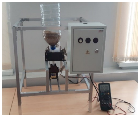
Рис. 1. Общий вид лабораторной установки магнитной стимуляции семян
