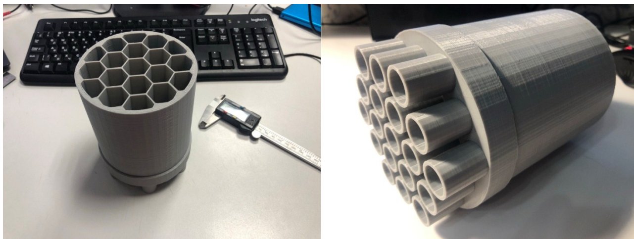
Рис. 1 Общий вид устройства для оценки распределения семян в вертикальном семяпроводе
