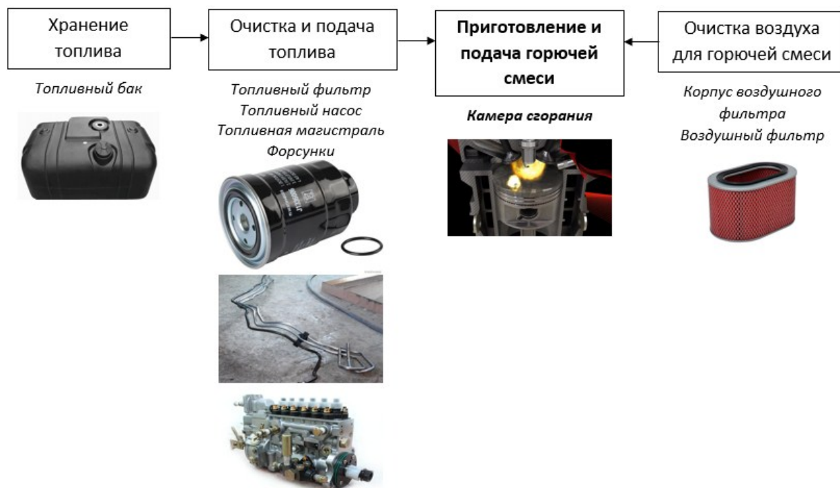
Рис. 1 Схема системы питания современного двигателя внутреннего сгорания
