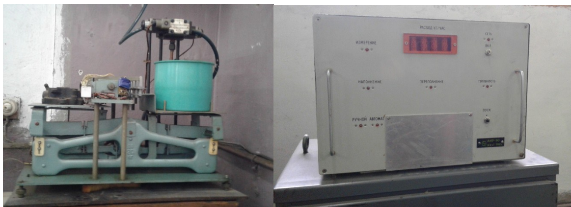
а) измерительно-расчетное устройство; б) весовой механизм Рис. 2. Измерительный комплекс АИР-50:
