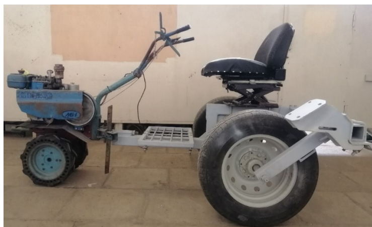
Рис. 3 – Самоходная сеялка на базе платформы для селекционных делянок
