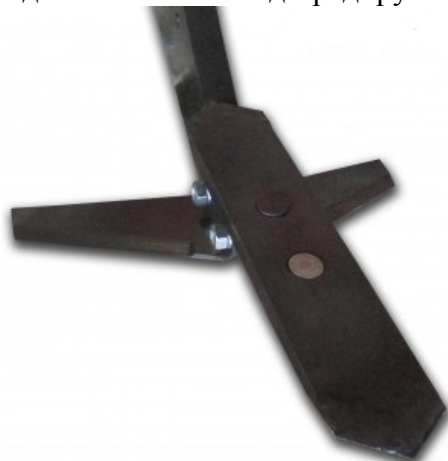
Рис. 2 Рабочий орган стерневого культиватора – рыхлителя
