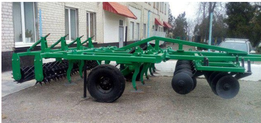
Рис. 2 Агрегат комбинированный широкозахватный для минимальной обработки почвы АКМ-4
