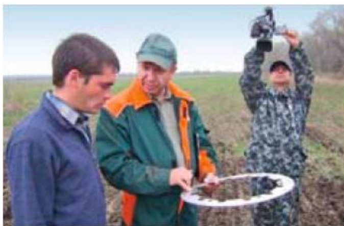
Рис. 2. Пластина для регулировки ширины междурядий сеялки Primera DMC 4500
