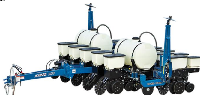
Рис. 2 Модернизированная сеялка Kinze 3000 для внесения жидких удобрений
