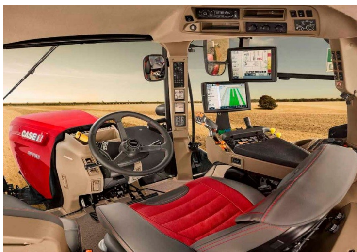
Рис. 1. – Рабочее место оператора, оборудованное системой Trimble
