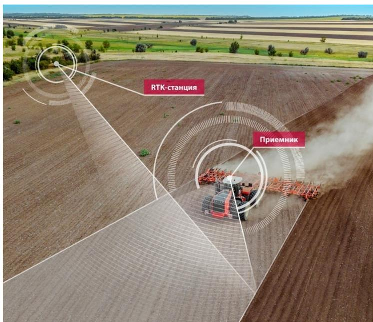
Рис. 1. Схема применения систем параллельного вождения при обработке почвы
