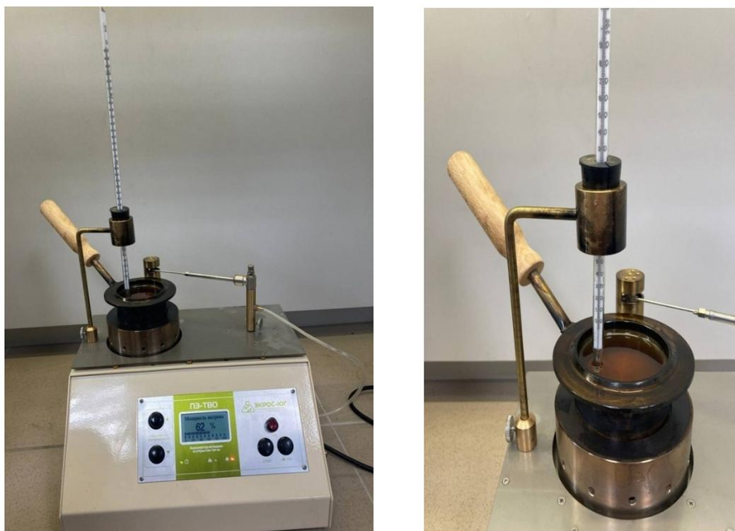
Рис. 1. Прибор ПЭ-ТВО для определения температуры вспышки масла в открытом тигле
