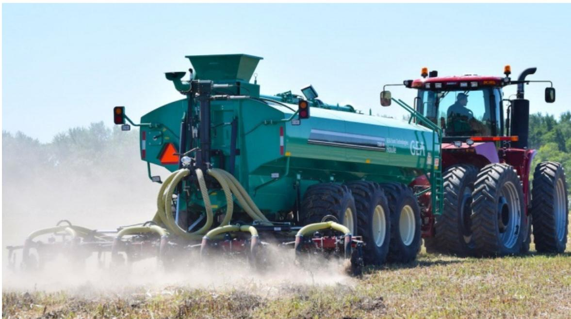
Рис. 1. Машинно-тракторный агрегат для внесения удобрений с бункером увеличенного объема
