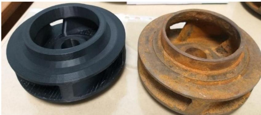
Рис. 1. Прототип рабочего колеса центробежного насоса
