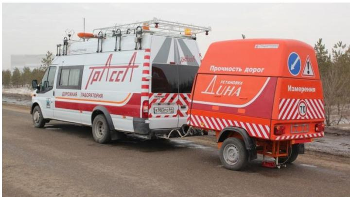
Рис. 2. Передвижной диагностический комплекс
