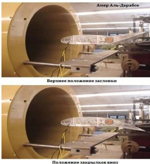
Рис. 9. Испытание системы приведения в действие закрылков при скорости аэродинамической трубы 21,3 м/с
