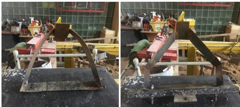
Рис. 1. Трапециевидный и параболический рабочие органы рыхлителя
