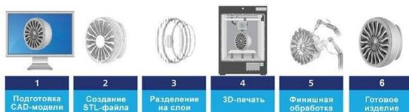
Рис. 1. Последовательность изготовления деталей с помощью аддитивных технологий
