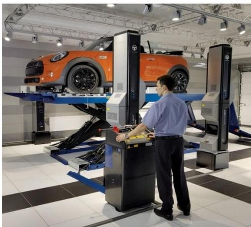
Рис. 1. Образец бесконтактного станда Техно Вектор 8 с технологией SMARTLIGHT
