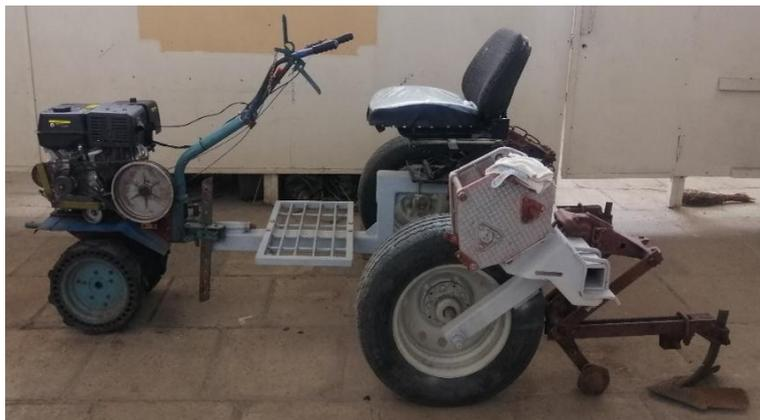
Рис. 2. Культиватор на базе самоходной платформы для селекционных делянок с рабочими секциями от КРН-4,2
