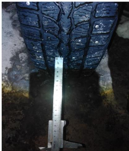
измерение остаточной высоты протектора
