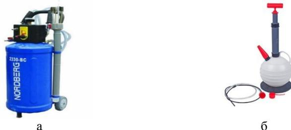
Рис. 1. Установки для сбора масла:
