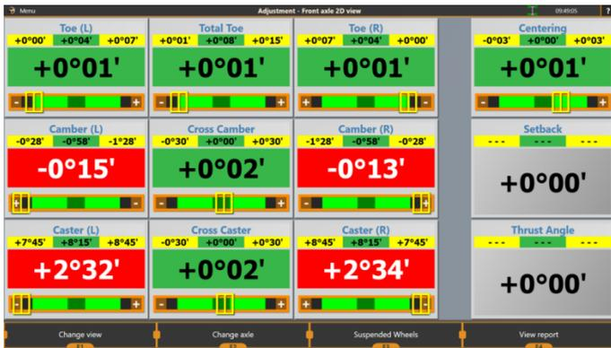
Рис. 5. Показания углов установки колес
