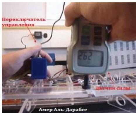
Рис. 8. Измерение силы срабатывания закрылка
