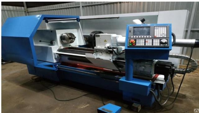
Рис. 2. Станок с ЧПУ 16к20ф3
