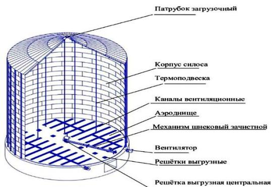
Рис. 1. Конструкция силоса
