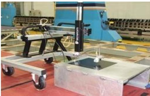
Рис. 5. Изображение алюминиевой формы с углепластиком, преобразователями и системой сканирования
