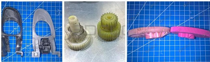
Рис. 4. Примеры изготовления методом FDM-печати деталей автомобилей взамен изношенных архангельской компанией 3Delo
