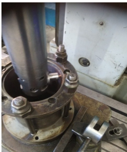
Рис. 4. Фотография рабочего положения приспособления для латунирования в гильзе цилиндров
