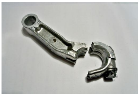
Рис. 2. Обрыв нижника шатуна
