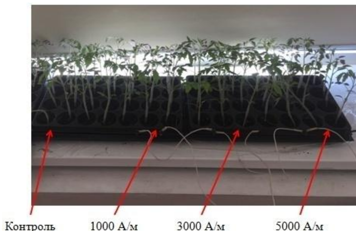
Рис.1. Экспериментальная установка стимуляции рассады томатов магнитным полем
