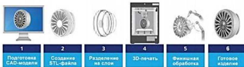
Рис. 1. Общая схема аддитивного производства
