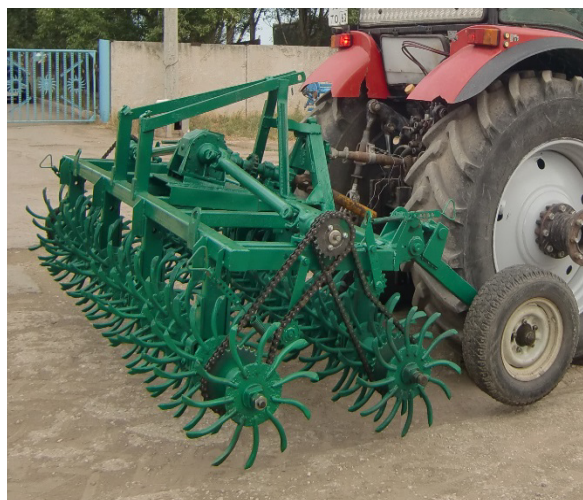
Рисунок 1. Тягово-приводное почвообрабатывающее орудие: 1 - рама; 2 - навесное устройство; 3,4 - игольчатые диски; 5 - конический редуктор; 6 - входной вал; 7 - карданный вал; 8 - выходной вал
