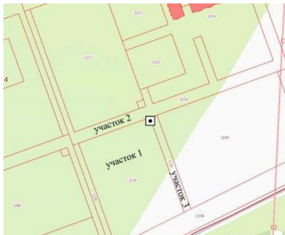
Рис. Пункт ОМС на пересечении трех земельных участков
