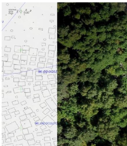
Рис. 5 Применение ортофотопланов для создания топографической карты при залесенной местности
