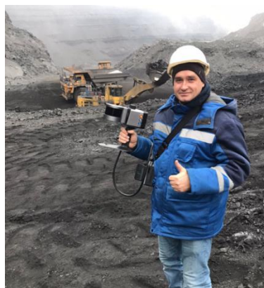
Рис. 1 Сканер GoSLAM RS100S в процессе эксплуатации
