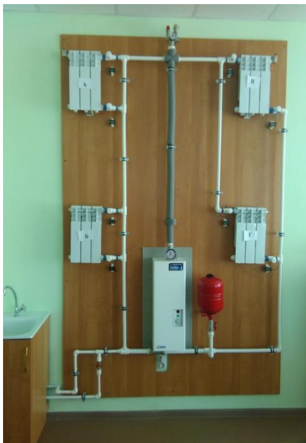
Рис. 3. Общий вид лабораторного стенда «Исследование систем отопления с естественной циркуляцией»
