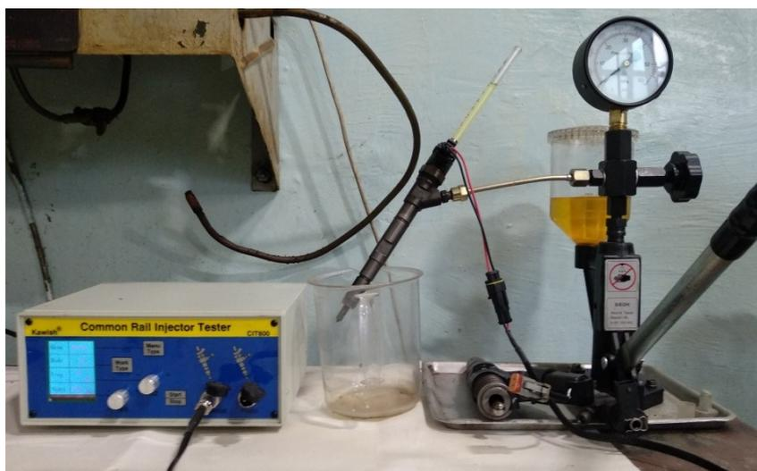
Рис. 1. Тестер форсунок CTR800 и прибор S60H
