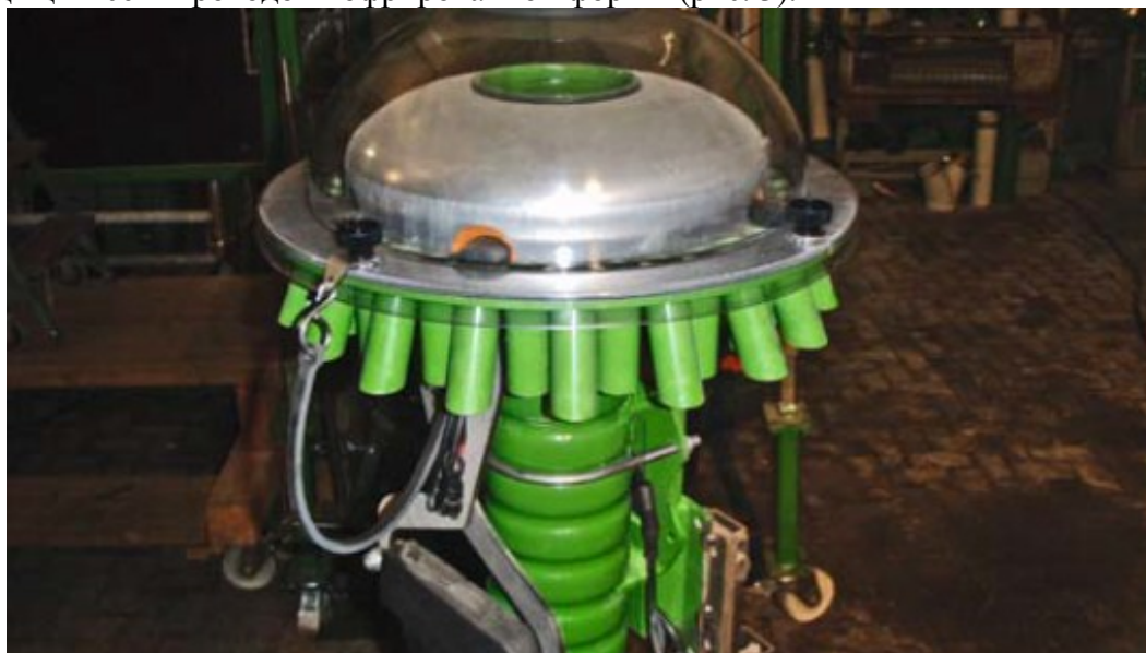
Рис. 3 Распределительное устройство сеялки Amazone Primera DMC
