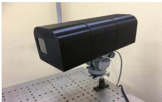
Рис. 2. Гиперспектральная камера на базе оптической схемы Оффнера
